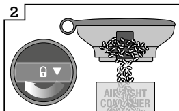
2 Tenez la trémie au-dessus du récipient et tournez la molette pour libérer les grains dans le récipient
